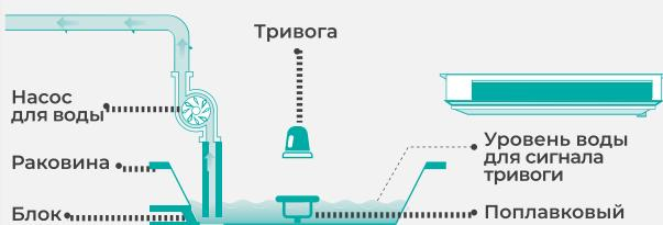
③ Когда уровень воды поднимается настолько, что датчик касается сигнала тревоги, кондиционер перестает работать.
