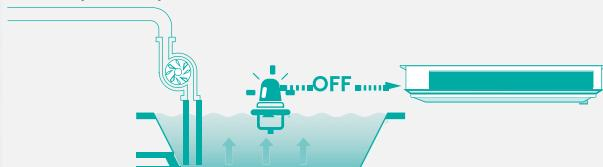
② Когда дренажный насос перестает работать, а уровень воды повышается благодаря большой конструкции сливного поддона, Кондиционер продолжает работать в нормальном режиме.
